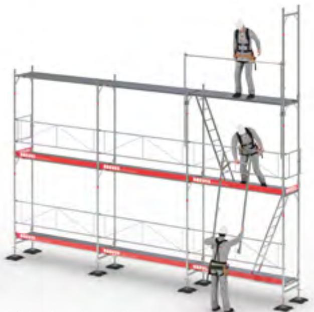
**Bild 18b:** Beispiel der Montage mit dem Vorausgeländer
