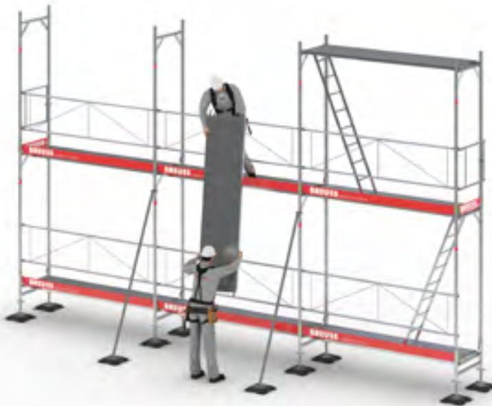
**Bild 16:** Beispiel einer vorübergehenden Kippsicherung der ersten Gerüstebene
