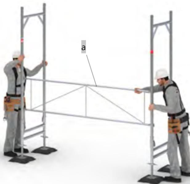
Bild 3: Aufbau des ersten Gerüstfeldes
